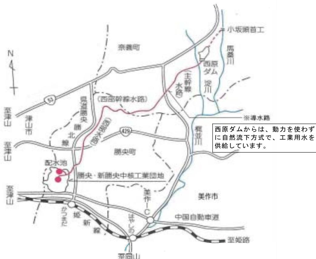
西原ダムからは、動力を使わずに自然流下方式で、工業用水を供給しています。
